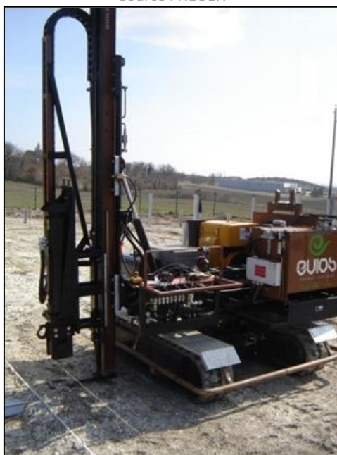
Illustration 48 : Engin de battage de pieux
